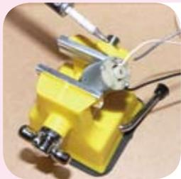
1. 先把電動機與電線焊接，然後再把電池箱接駁在箱外鑽一小孔，與開關掣配合，形成閉合電路。
