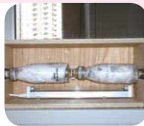
5. 把濾水器連接到自來水喉，然後連續三個星期各取樣本一次，分別進行沈澱物和細菌的測試(見表三、表四、表五)。
