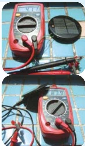
用兩塊並聯可以得到139毫安培的短路電流
