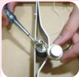
3. 利用螺絲帽把電動機的軸心固定，然後利用文件夾的金屬扣作為磁石的承托。再在鋁條的兩端，用紙盒載入碎石。
