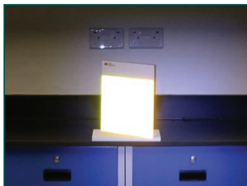
圖五：回反射膜可以在任何角度把光線沿入射方向反射，所以在光源附近觀看，回反射膜顯得十分明亮。
