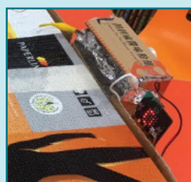
圖 13：Micro:bit 自動計分裝置
