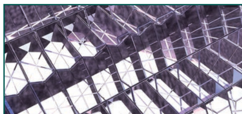
圖六：回反射膜的放大照片，可見每個單元都是由數塊鏡子組成。
