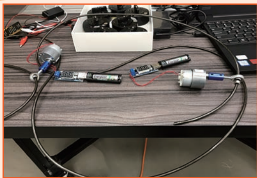
(利用USB電壓計測量不同減速電機的出電效能。)
