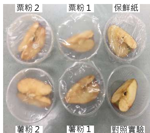
圖3.4 蘋果片在不同物料包裝下的氧化過程(90分鐘)
